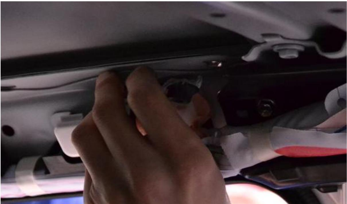
6. После установки закладных ,подрезаем штатные молдинги крыши и устанавливаем их на место
