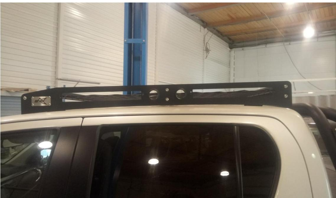
3. Просверливаем сверлом , диаметром 8мм, отверстия для крепления пластин , **позиция 1**
