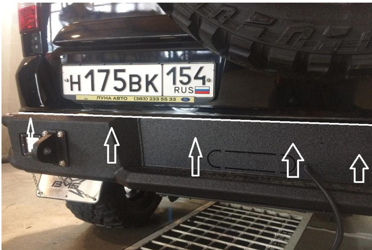
5. Отрезаем по линии нижнюю часть бампера, которую мы отметили
