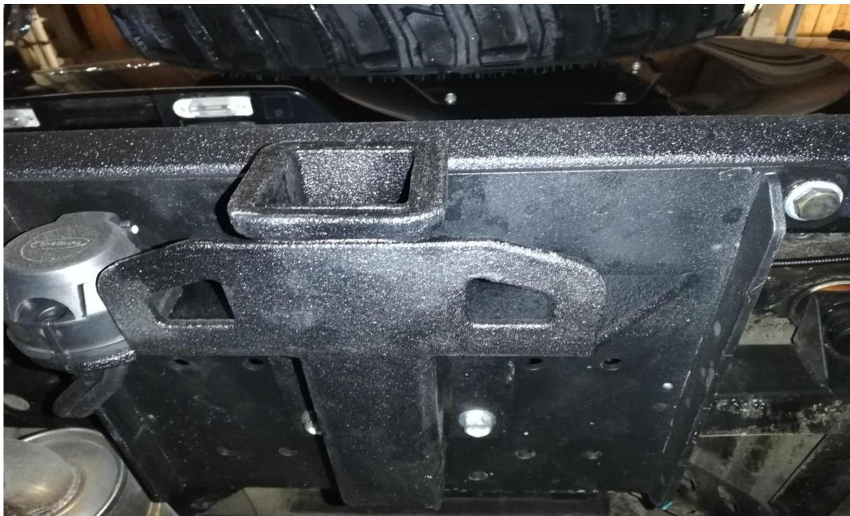
Также дополнительно, в окошки бампера предусмотрена, установка светодиодных фар. Для этого имеются все крепления.
