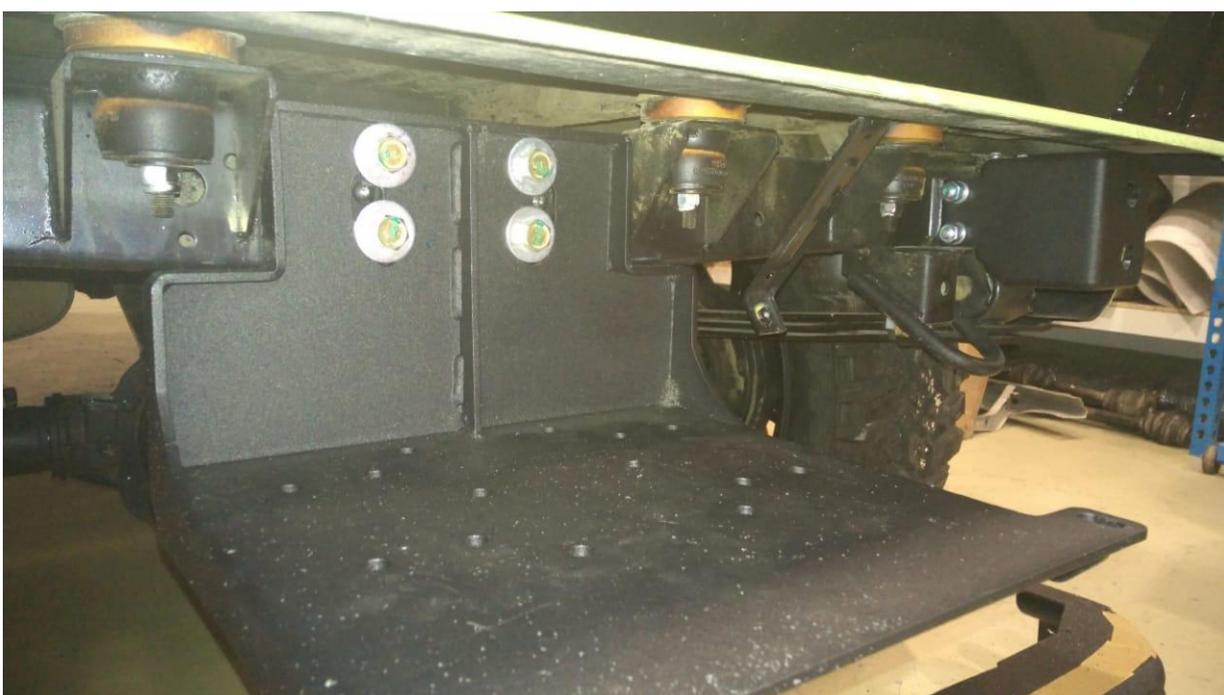
8. Устанавливаем собранный бампер на кронштейны **2,3** , прикручивая комплектным крепежом **18,19,20,21,22,23**. Регулируем бампер в кронштейнах, выставляя нужный нам наклон бампера, шайбами. И прикручиваем площадку под лебедка к бамперу. Подкладывая их под нижнюю или верхнюю часть кронштейнов
